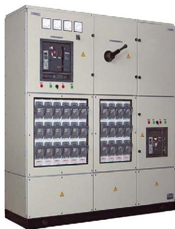
\\ НКУ ЩО-2000 «Нева»: 1 секция, 10 отходящих присоединений с защитой предохранителями, отходящая линия с защитой автоматическим выключателем
