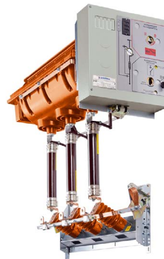
// Выключатель нагрузки трехпозиционный элегазовый с предохранителями SL-BTA ( I_{\text{ном}} = 630 \text{ А} ) //
